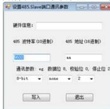
图8.设置RS485通信参数
